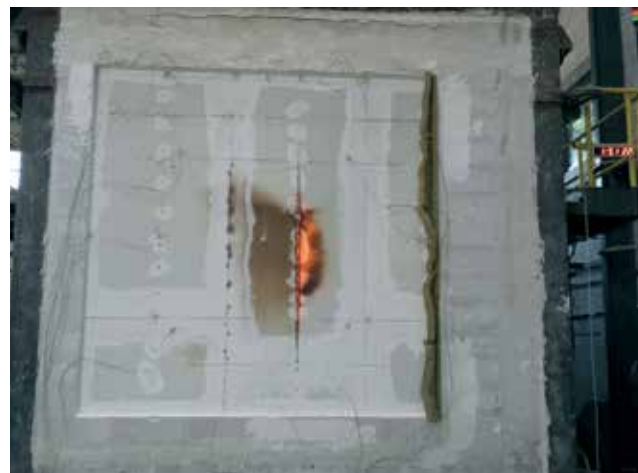
Imagine din exteriorul cuptorului de testare cu față neexpusă la foc a peretelui
