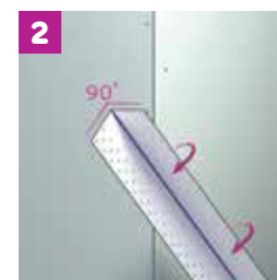
2 Se pliază banda de-a lungul perforației în unghi de 90° sau altul, după caz
