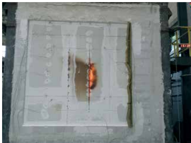
Imagine din exteriorul cuptorului de testare cu fața neexpusă la foc a peretelui
