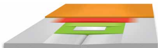
Q2 + 1 strat de glet pe toată suprafața plăcii
