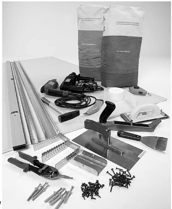
Fig. 1. Unelte utilizate pentru montarea sistemului de gips-carton
