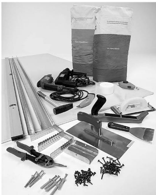
Fig. 1. Unelte utilizate pentru montarea sistemului de gips-carton
