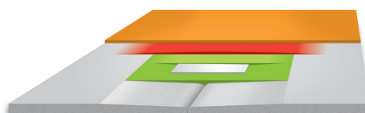
Q2 + 1 strat de glet pe toată suprafața plăcii
