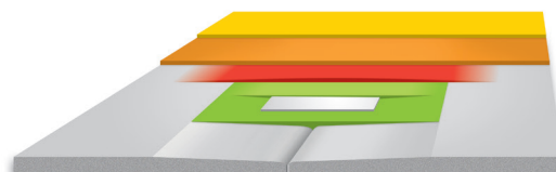
Q3 + 1 strat de glet ultrafin pe toată suprafața plăcii
