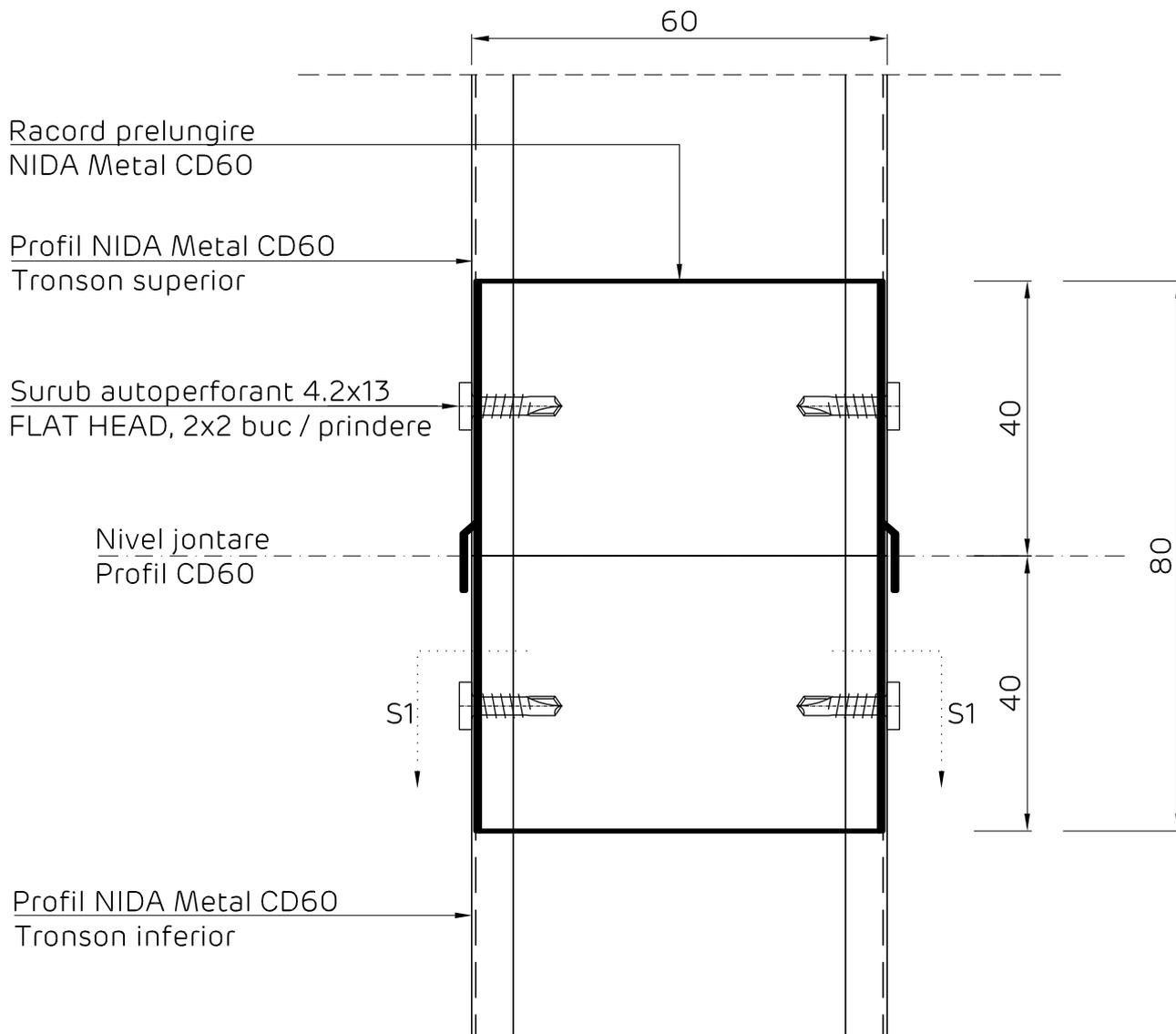
Secțiune S1 - S1
